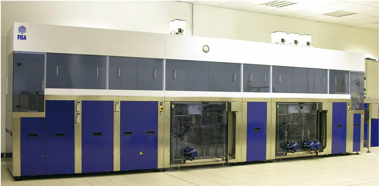
Abb. 1: CC-Hartlackbeschichtungsanlage mit je zwei Beschichtungs- und Infrarotmodulen
